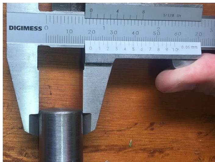
Figura 10 - Medida do diâmetro do eixo (Fonte: Autores)
