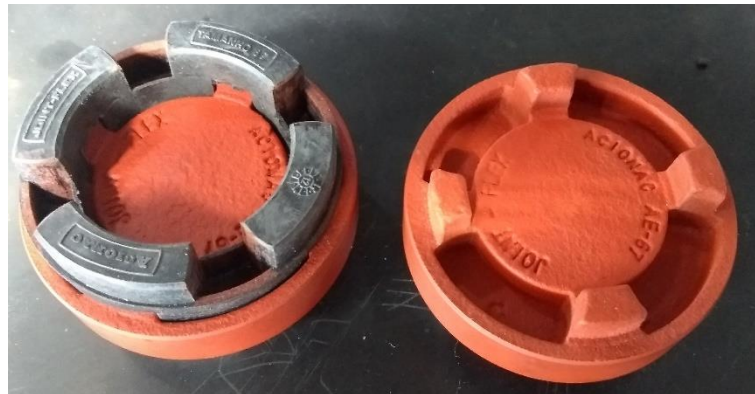
Figura 8 – Acoplador elástico AE-67 utilizado nos ensaios (Fonte: Autores)
