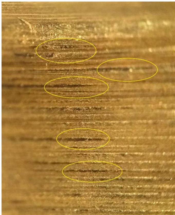
Figura 15 - Superfície da bucha ensaiada sem lubrificação (Fonte: Autores)
