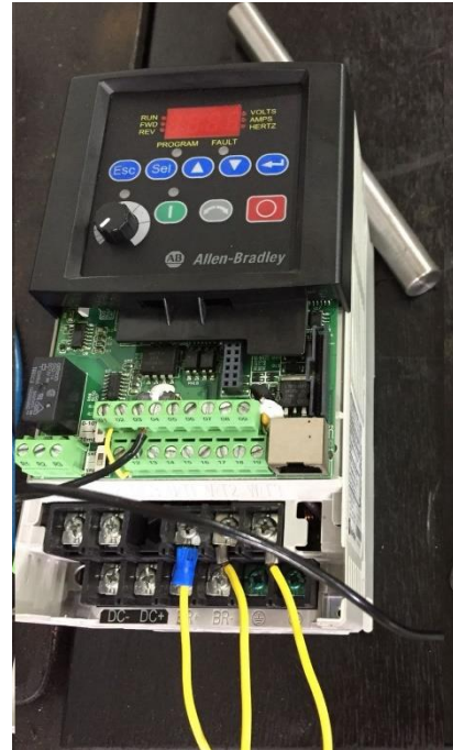
Figura 6 – Inversor de frequência utilizado para controlar a rotação do motor (Fonte: Autores)
