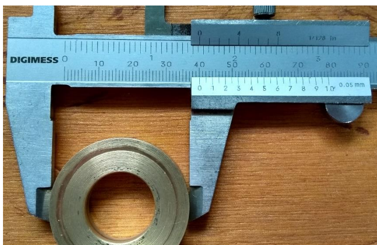
Figura 12 - Medida do diâmetro externo da bucha (Fonte: Autores)
