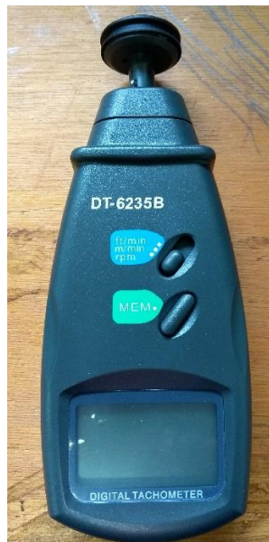
Figura 7 – Tacômetro digital utilizado nos ensaios (Fonte: Autores)
