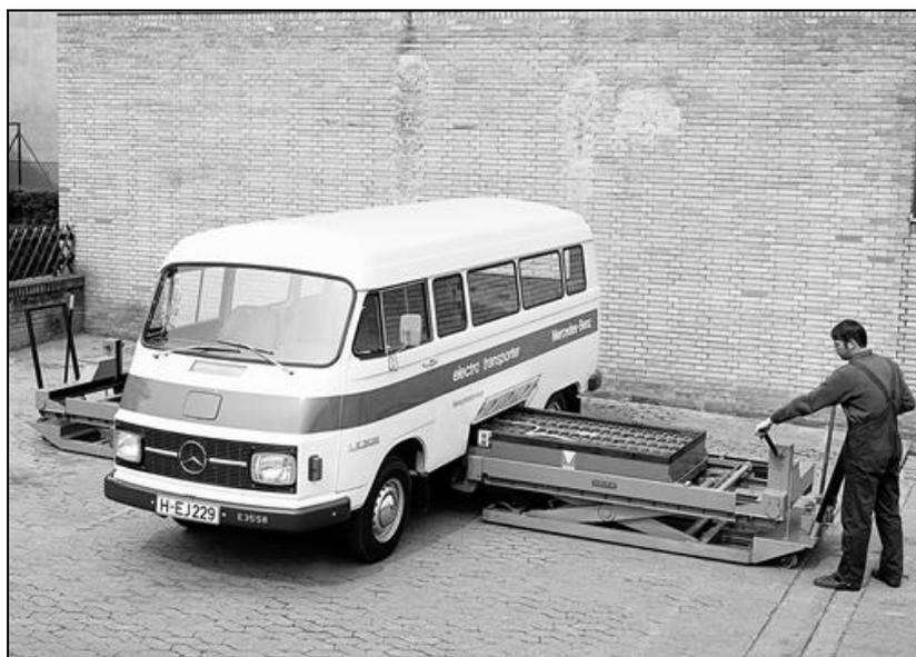
**Figura 3:** Furgão elétrico modelo LE306 produzido pela montadora Mercedes Benz na Alemanha, com dispositivo de troca rápida do banco de baterias
