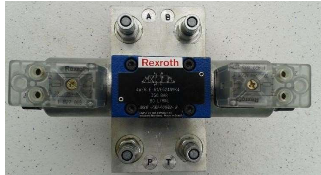
Figura 5 - Válvula bidirecional 4/3 vias
