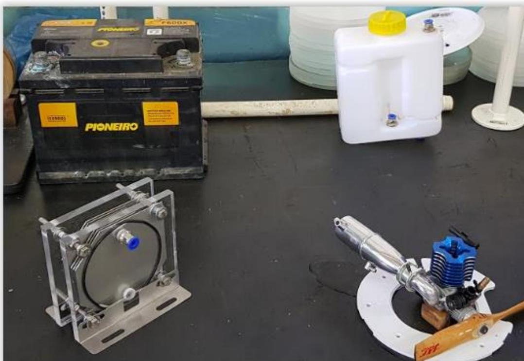
**Figura 3:** Foto dos componentes essenciais para o gerador de hidrogênio aplicado ao motor ciclo Otto.
