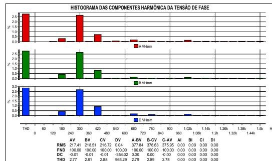
**Figura 21:** Histograma das harmônicas de tensão.
