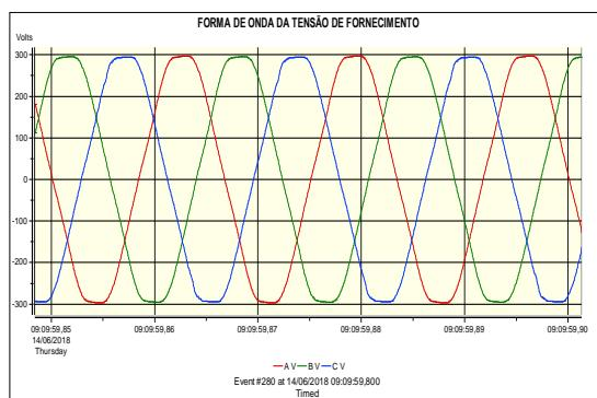
**Figura 34:** Forma de onda da tensão de fase.
