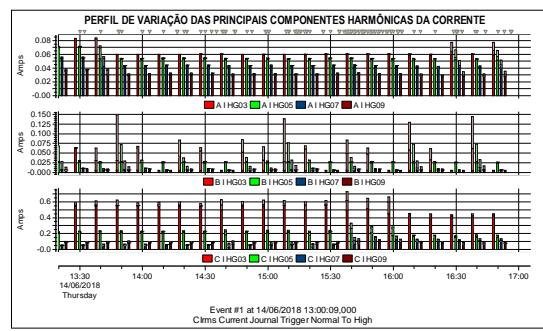
**Figura 29:** Perfil das harmônicas de corrente.
