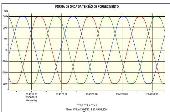
**Figura 30:** Forma de onda da tensão de fase.
