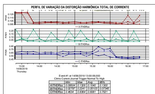
**Figura 27:** Perfil da distorção total de corrente.
