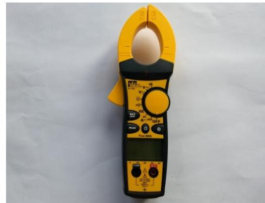
**Figura 13:** Volt-amperímetro alicate 61-766.
