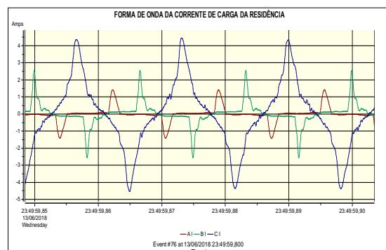
**Figura 31:** Forma de onda da corrente de linha.
