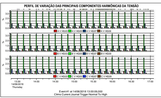
**Figura 28:** Perfil das harmônicas de tensão.
