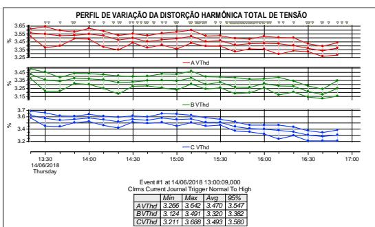
**Figura 26:** Perfil da distorção total de tensão.
