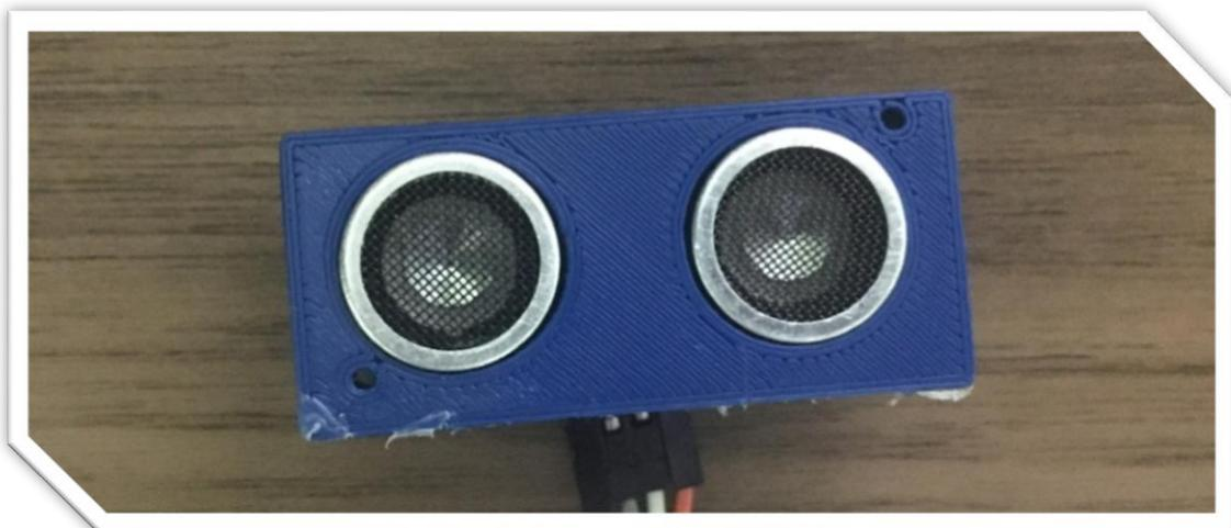
Figura 3: Sensor Ultrassônico de distância HC-SR04 Shield Arduino
