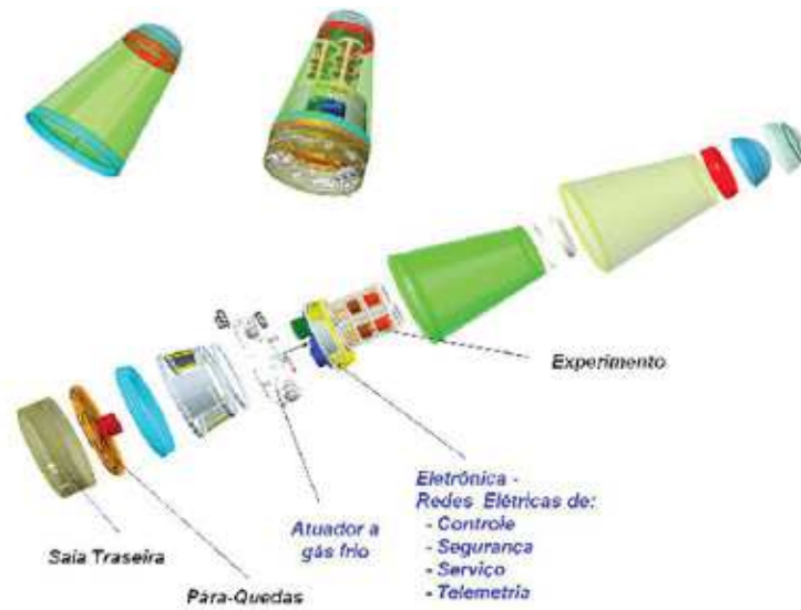
Figura 5: Vista explodida do satélite SARA suborbital e seus subsistemas internos.
