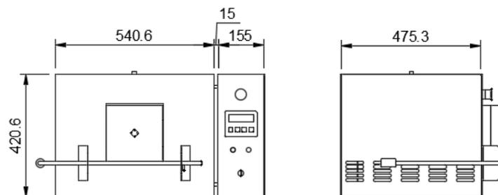
**Figura 10:** Dimensões do Forno
