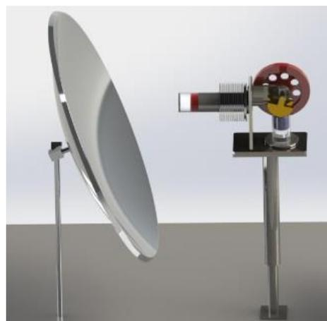
**Figura 10:** Esquema de aquecimento do cilindro.
