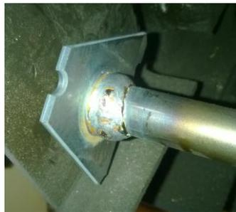
**Figura 13:** Foto de um cordão de solda homogêneo (Solda em ótimas condições)
