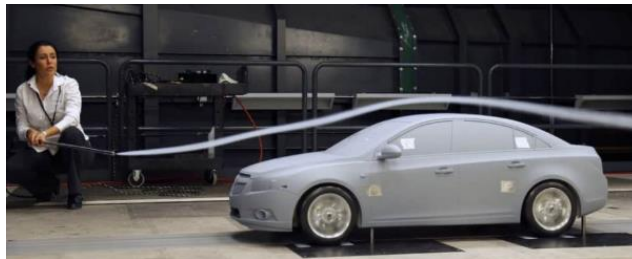
Figura 4: Impressão 3D em ensaios aerodinâmicos na indústria automotiva
