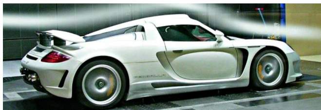
Figura 3: Ensaio em escala real em um túnel de vento
