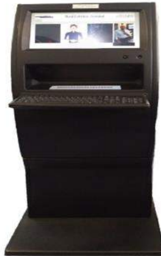
Figura 3 - Mural Eletrônico Acessível com Braille Dinâmico Fonte: Instituto Nacional de Tecnologia – INT & Clara Ideia (2020).
