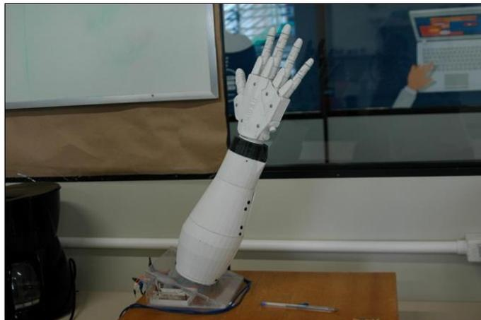
**Figura 9:** imagem real da prótese robótica
