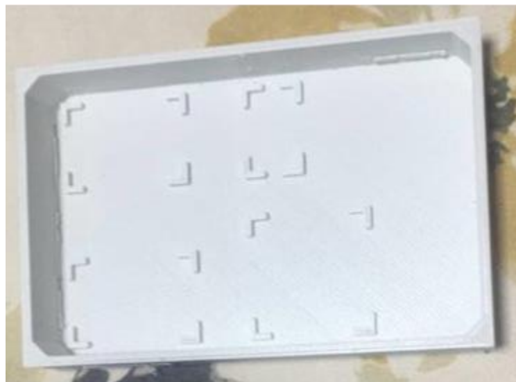
Figura 3. Resultado impressão caixa principal onde o conversor Analógico/Digital, Módulo GPS e Driver de Acionamento seriam conectados.
