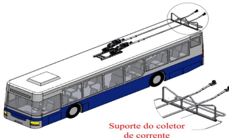
**Figura 5:** Posição de repouso do coletor de corrente
