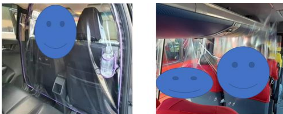
Figura 1 – Implementação das barreiras flexíveis
