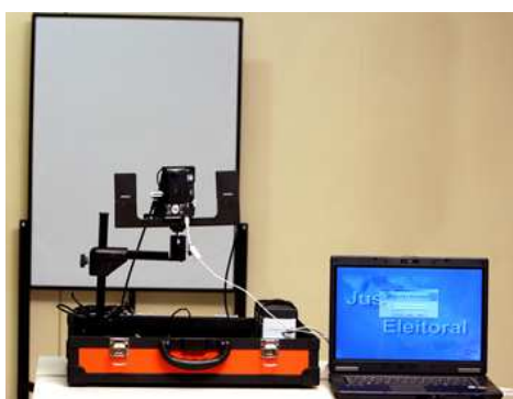
Figura 6: Kitbio completo com laptop, sensor de digitais, mini-estúdio fotográfico e caixa de transporte
